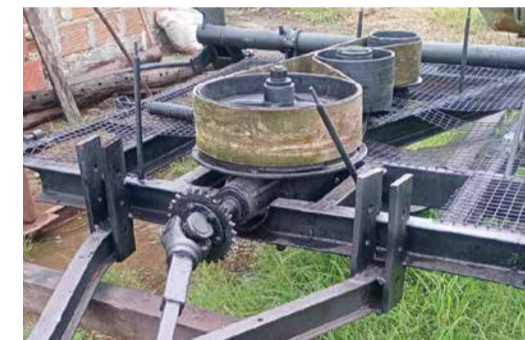
Demalezadora con enganche, de 1,5 m de ancho de labor.
