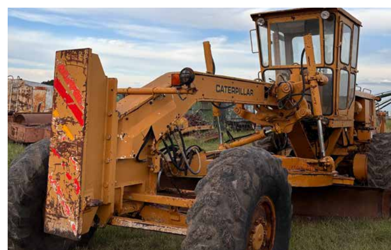
Motoniveladora Caterpillar. 14 G. Hidráulica.
