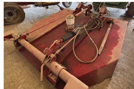
Yomel TM 2 4. Cilindro hidraulico para altura. Caja Eaton. Ancho de labor 1,5 m. Sin cardan.
