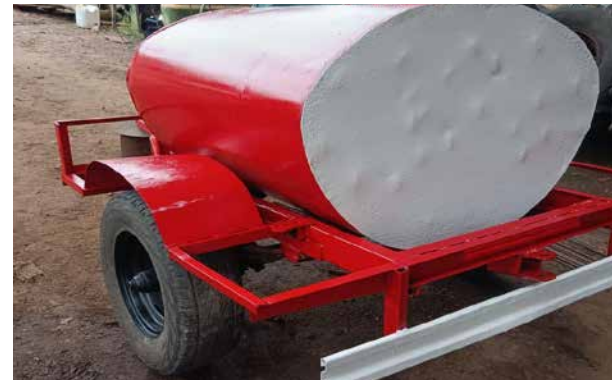
Cisterna roja. De un eje. Sin bomba surtidora
