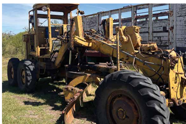
Motoniveladora. SIAM Wabco 440. GM 4 Cilindros. Hidráulica. Pala de 4 m de ancho. Cubiertas: 13.00-24" / 14.00-24'
