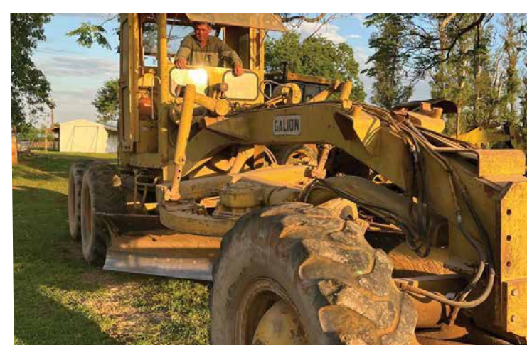
Motoniveladora .Galion KCE 1. Motor SCANIA. 4 M DE PALA Rod: 1300-24
