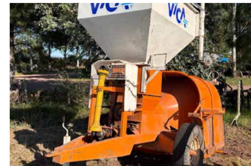
Embolsadora VICA. Capacidad 100 kg. Material de chapa. Barra de comando cardánica.
