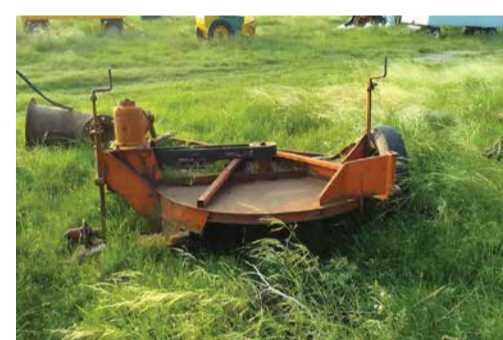
Desmalezadora Ardanaz BD. Sin correa y sin una cuchilla. 2 m ancho de labor.
