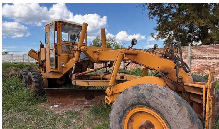
Huber Warco 110. Cuchilla de 4m, caja nueva. Bomba hidráulica nueva. Rod 1400-24. Motor Fiat
