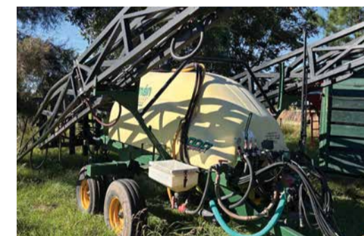
Fumigadora Caiman 3000A. 3000 L de capacidad. Rod 16 al 70 % (3). Dos ejes
